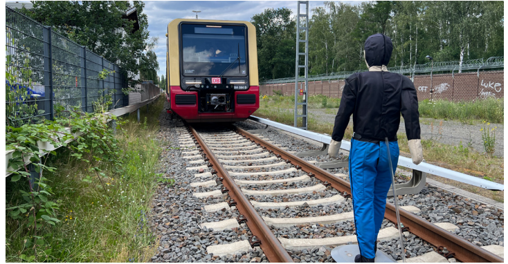
BerDiBa Projekt – Test der automatischen Hinderniserkennung
