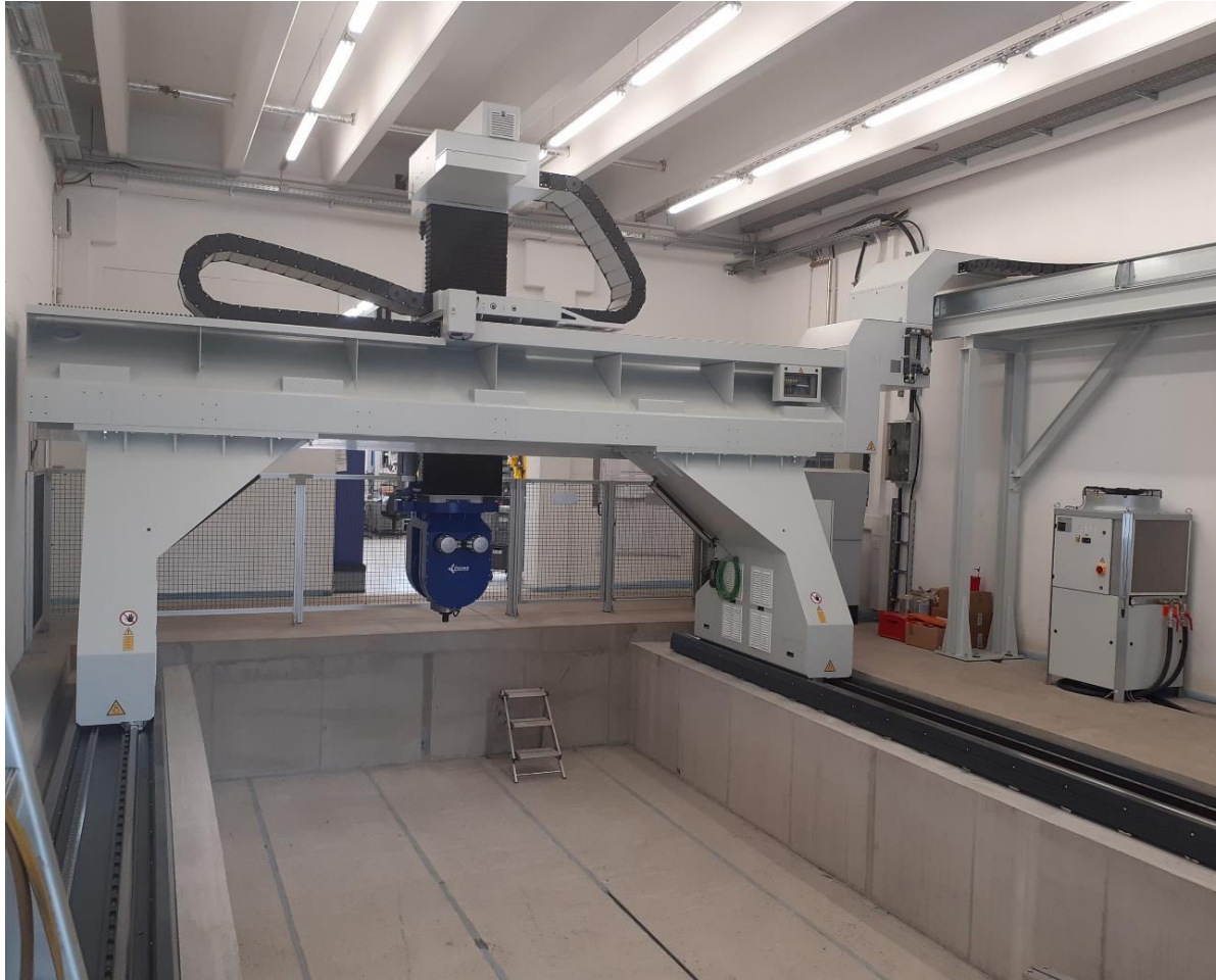
+ DEMONSTRATIONSLABOR RÜHRREIBSCHWEISSEN (FSW) IN DER SLV BERLIN-BRANDENBURG
