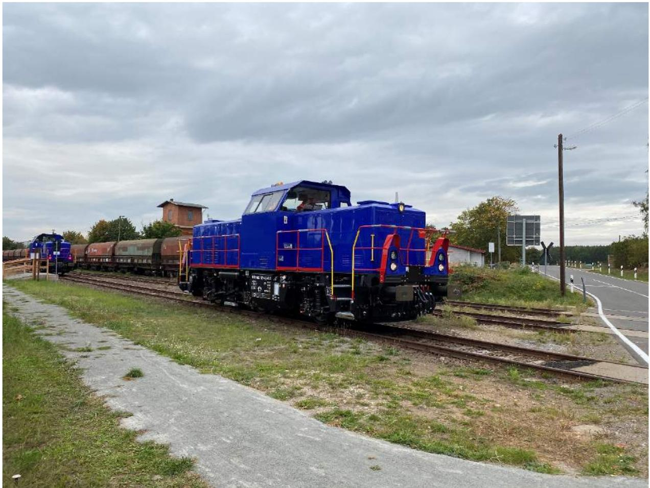
Lastprobefahrten mit neuen H3-Loks bis 100 km/h (Fa. Alstom)
