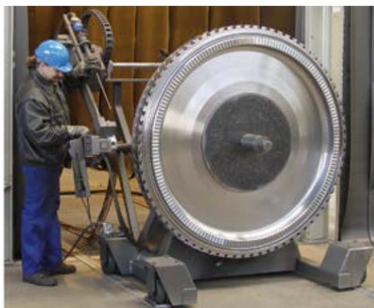
Mittels Shot Peening werden beispielsweise bearbeitet: Zahnräder, Antriebswellen, Lenkungs- und Fahrwerksteile, Turbinenschaufeln, Motorenteile, Implantate, Strukturbauteile und Schweißverbindungen. Hinsichtlich Größe und Gewicht der Bauteile sind dem kontrollierten Kugelstrahlen keine Grenzen gesetzt.
