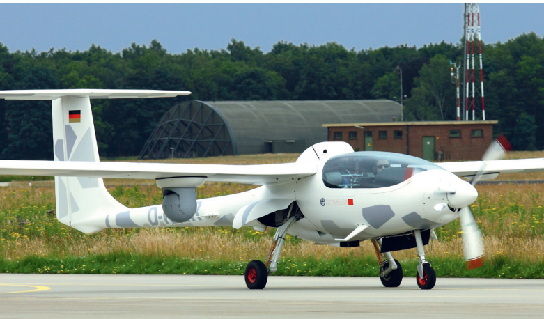
Die Arbeitsplattform S 15 trägt unter den Flügeln zwei Payloads, das sind individuelle Sensoren.
