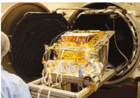
Der MASCOT Lander während des Tests des thermischen Kontrollsystems (mit freundl. Genehmigung DLR)
