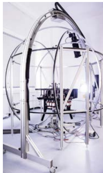
Attitude Control System – Teststand für Kleinsatelliten
