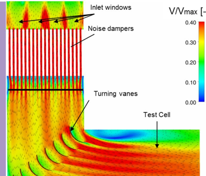
Numerische Simulation des Systems Triebwerk - Prüfzelle
