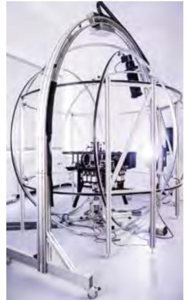
Attitude Control System – Teststand für Kleinsatelliten
